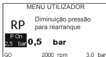
Figura 17: Programação da pressão de re arranque
