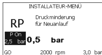
Abbildung 17: Einstellung des Neustartdrucks
