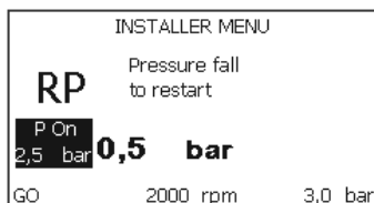
Obr. 17: Nastavení tlaku znovuspuštění
