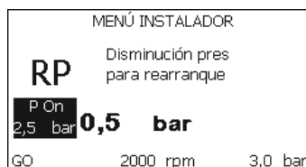
Figura 17: Configuración de la presión de reencendido
